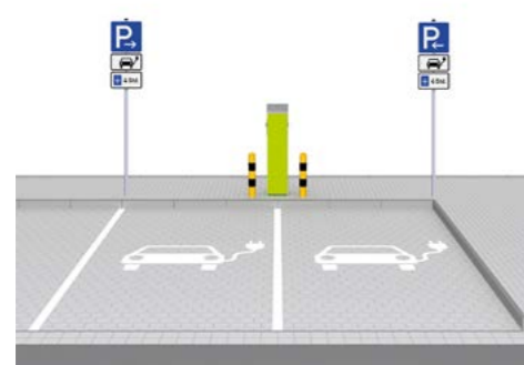
Kennzeichnung einer Ladestation für elektrisch betriebene Fahrzeuge nach EmoG (nur mit E-Kennzeichen) im öffentlichen Verkehrsraum. Die Markierung der Stellflächen muss als weißes Sinnbild nach §39 Abs. 10 StVO ausgeführt sein.
